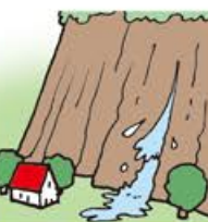
斜面から水がふき出す
