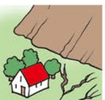
地面にひび割れができる
