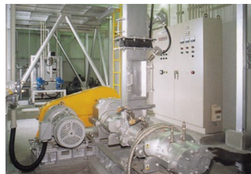
●ダスト安定化装置 有害な貴金属を無害化する装置です。
