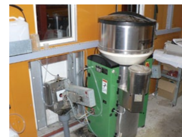
子牛にミルクをあげるロボット
